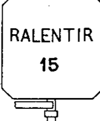
Signaux placés sur les ponts tournants pour machines face avant (A)
