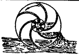
Un courant fait mouvoir la roue; la forme particulière de ses aubes lui permet en même temps d'élever de l'eau qui se déverse dans l'axe creux, et de la dans un bassin supérieur au courant.
